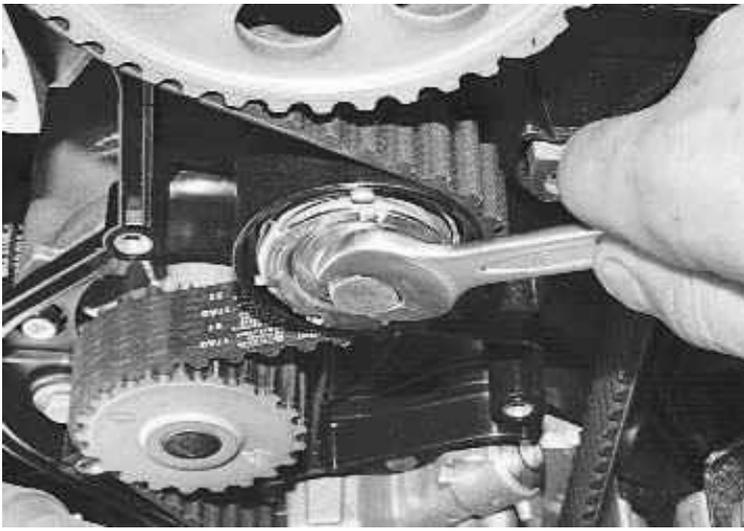
24. ...и снять ремень привода газораспределительного механизма.
