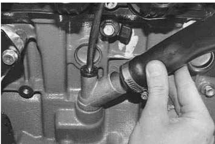
11. Вывернуть винт крепления кронштейна направляющей указателя уровня масла (щупа)...
