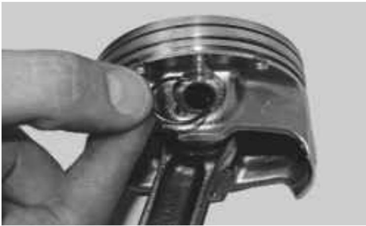
99. С помощью оправки извлечь палец из поршня и снять поршень с шатуна.
