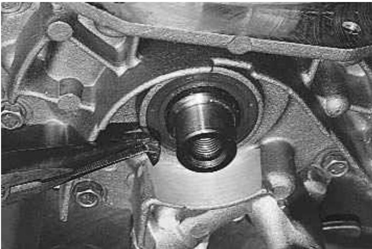
82. Ключом «на 10» вывернуть шесть болтов крепления масляного насоса и снять насос.
