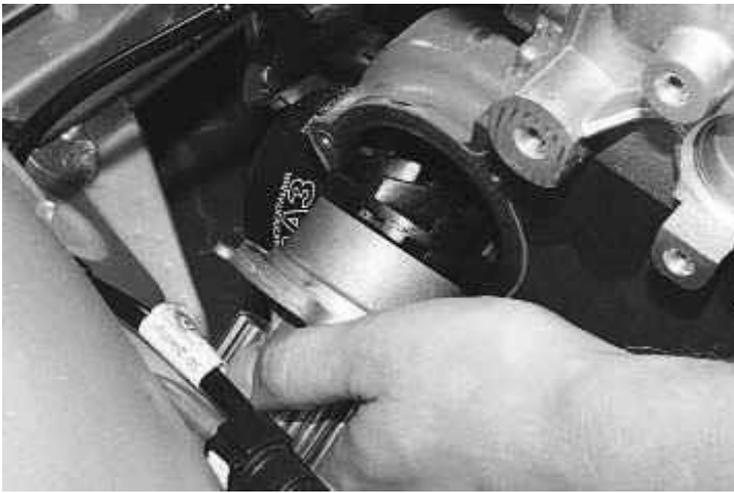
65. Снять с насоса прокладку.
