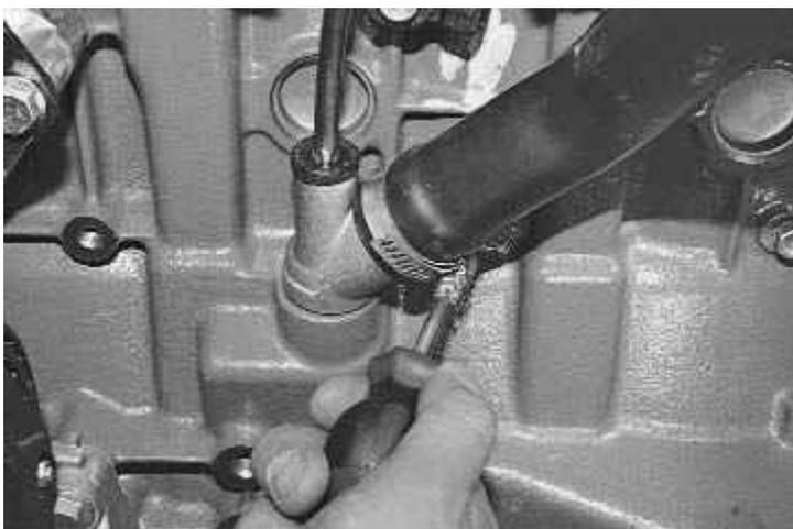
10. ...и снять вытяжной шланг системы вентиляции картера с патрубка блока цилиндров.
