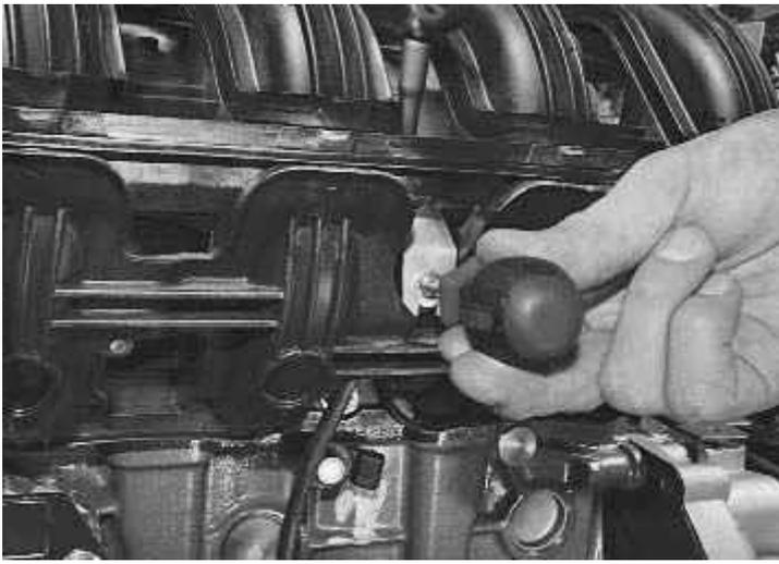
12. ...и снять направляющую вместе с указателем.
