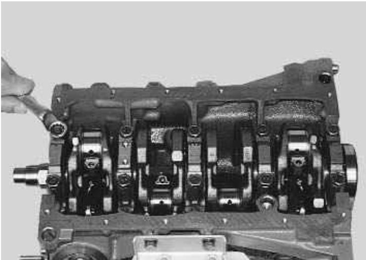
91. ...и снять крышки.
