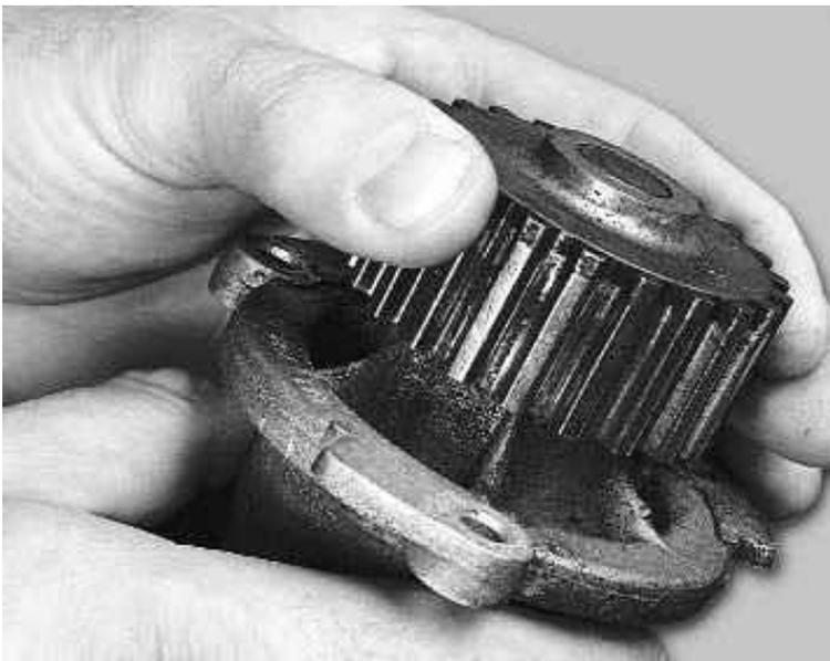
68. ...обнаружены трещины, сколы, выкрашивания на зубчатом шкиве 1, крыльчатке 2 и корпусе 3 насоса.
