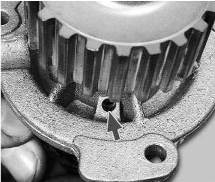
67. ...есть заметный осевой люфт валика насоса (поврежден подшипник насоса)...
