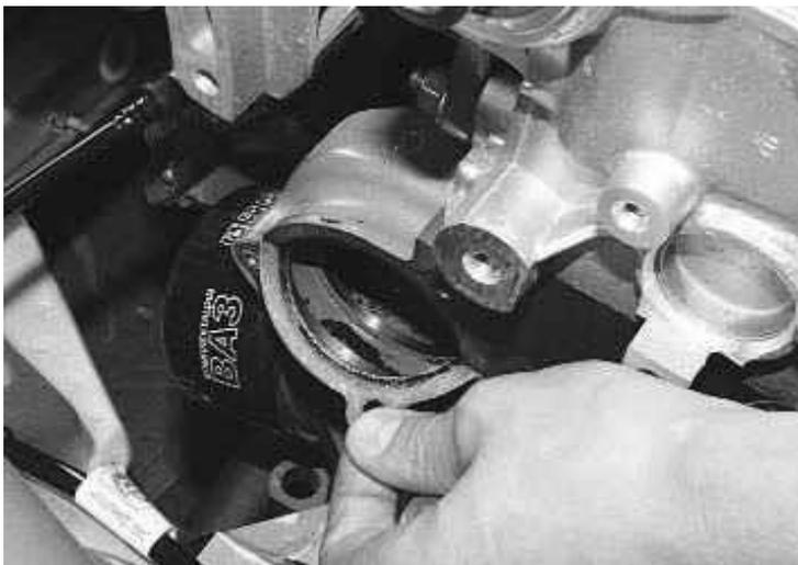
66. Заменить водяной насос, если обнаружена утечка охлаждающей жидкости через дренажное отверстие (поврежден сальник насоса)...
