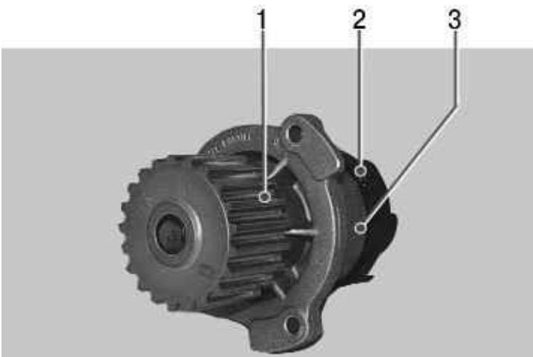
69. Проверьте затяжку стопорного винта подшипника насоса. При необходимости затянуть винт.
