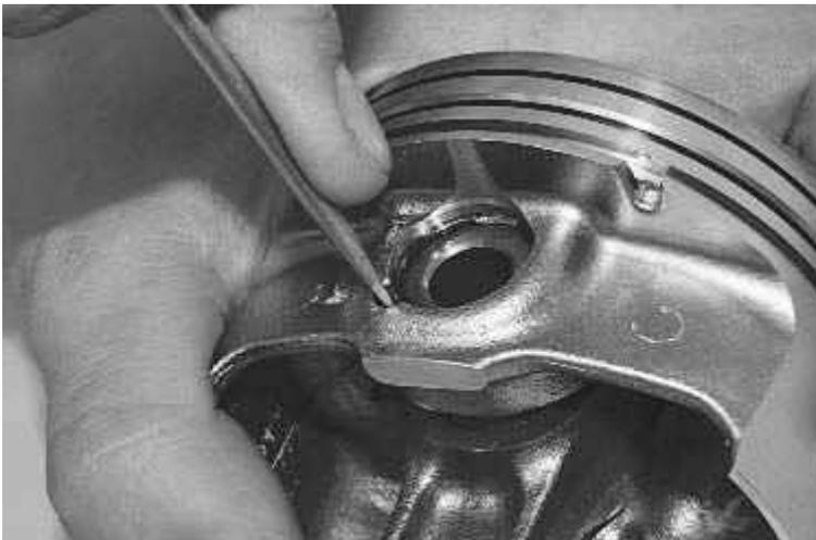
98. ...снять стопорное кольцо, удерживающее поршневой палец. Аналогично снимите второе стопорное кольцо.
