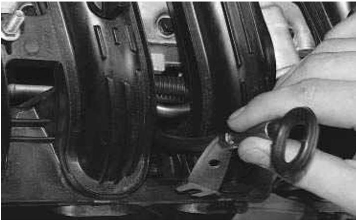
13. Отвернуть ключом «на 10» две гайки крепления впускного коллектора к крышке головки блока.
