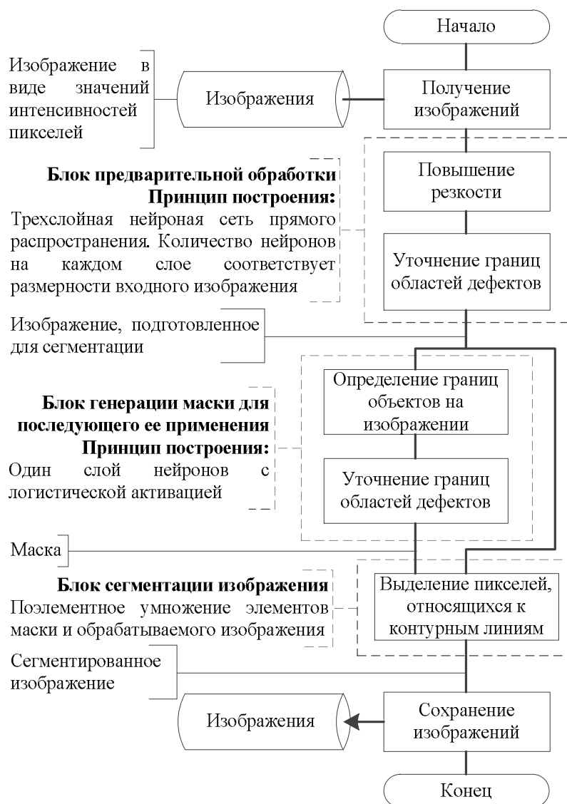
Рисунок 7 – Схема нейросетевой структуры для сегментации низкоконтрастного изображения
